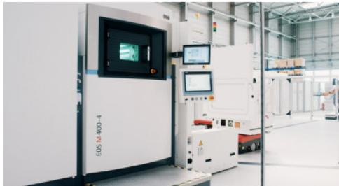
Das auf der EOS M 400-4 additiv gefertigte Bauteil wird in einem Container mittels fahrerlosem Transportfahrzeug zur nächsten Station befördert (Quelle: EOS).
