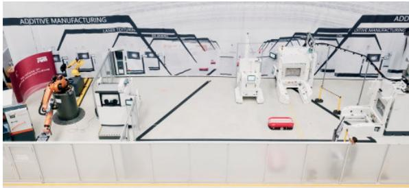
Die aufgebaute Pilotanlage des NextGenAM Projekts zur automatisierten additiven Fertigung im Detail, v.l.n.r.: Bandsäge, Kuka-Roboter, dahinter: 3D-Vermessungsstation (Geometrisch Optische Messung / GOM), Rüststation, Auspackstation, davor: Transportfahrzeug (AGV), EOS M 400-4, nicht im Bild: Pulverstation IPM M Powder Station L von EOS (Quelle: EOS).
