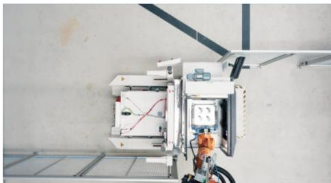
Ein Roboter entnimmt die additiv gefertigten Bauteile, die sich noch auf der Bauplattform befinden (Quelle: EOS).
