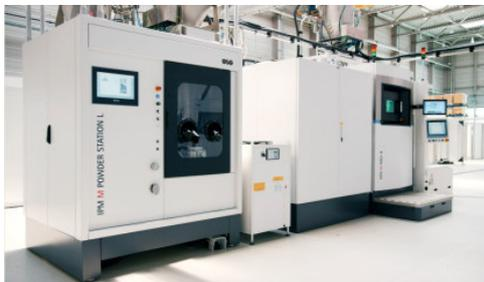
Die Pulverstation IPM M Powder Station L versorgt die M 400-4 mit Pulverwerkstoff vor und während der Bauzyklen und sichert ausreichende Materialverfügbarkeit (Quelle: EOS).
