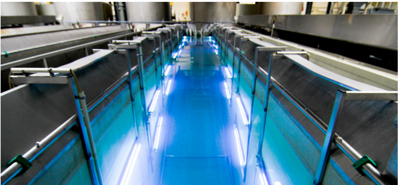
Galvanik-Spülbad der TSA-Anodisierreihe mit UV-Lampenausstattung
